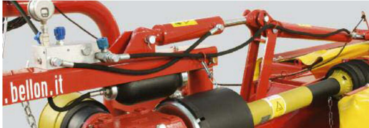
Tutto il sistema meccanico costituito da molle viene eliminato e sostituito a un accumulatore di azoto che riduce i tempi delle regolazioni manuali: ora basta caricare il circuito idraulico e regolarlo sui 50 bar e si può iniziare a falciare.
