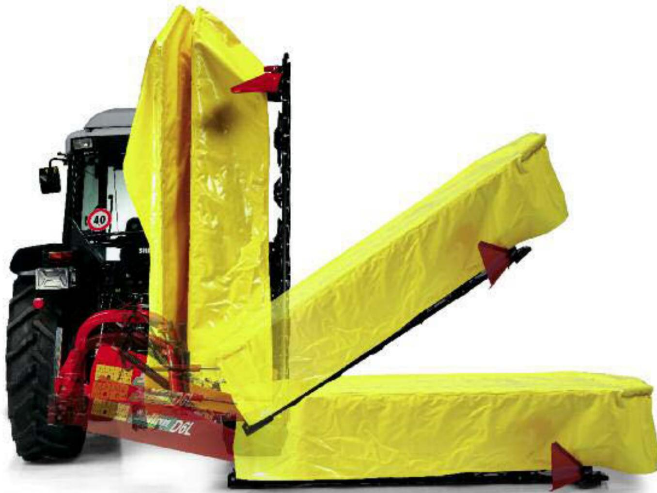
Tramite il dispositivo idraulico la falciatrice si solleva verticalmente a 90° ottenendo una elevata stabilità di marcia e sicurezza nel trasporto poiché la falciatrice è contenuta nelle dimensioni del trattore,
