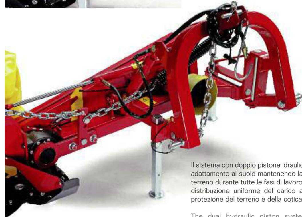
Il sistema con doppio pistone idraulico consente un ottimo adattamento al suolo mantenendo la falciatrice parallela al terreno durante tutte le fasi di lavoro. Inoltre si ottiene una distribuzione uniforme del carico al suolo ed un'ottima protezione del terreno e della cotica erbosa.
