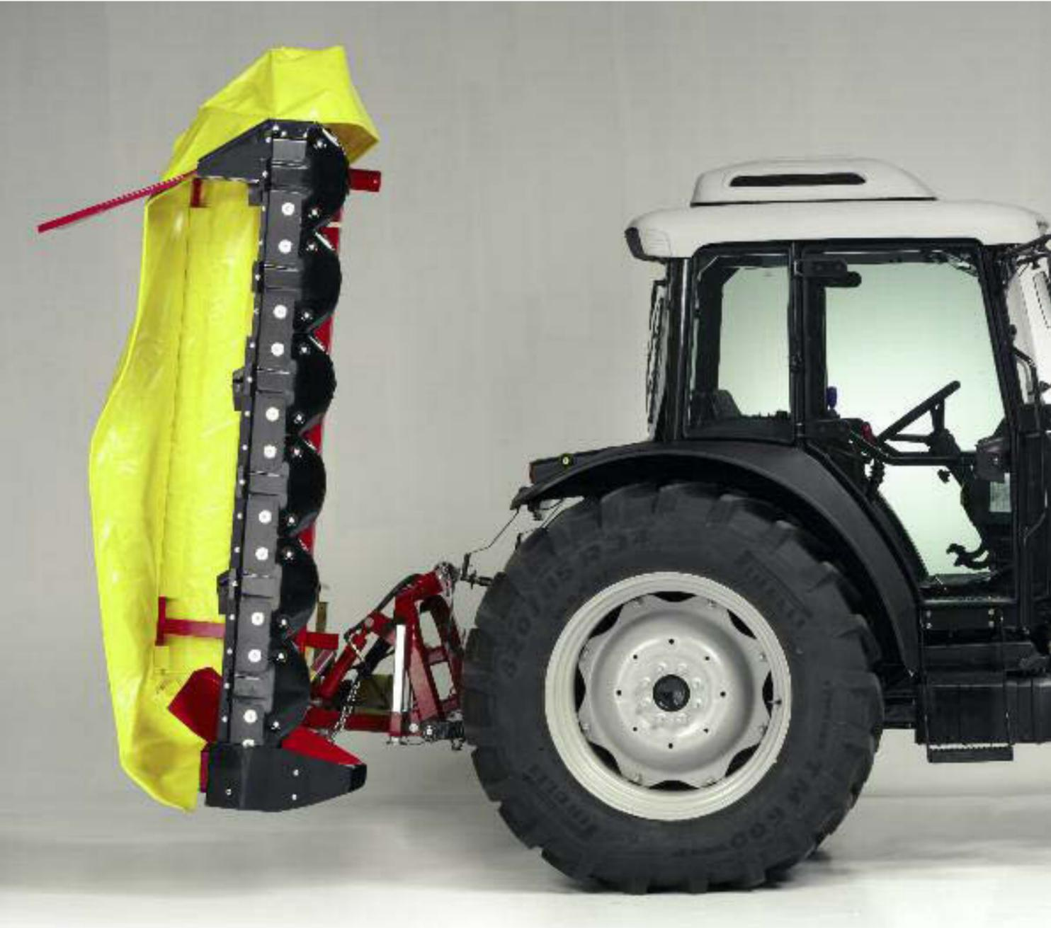
La tecnologia del sollevamento dell'elemento laterale tramite pistoni idraulici consente le ridotte dimensioni durante il trasporto.
