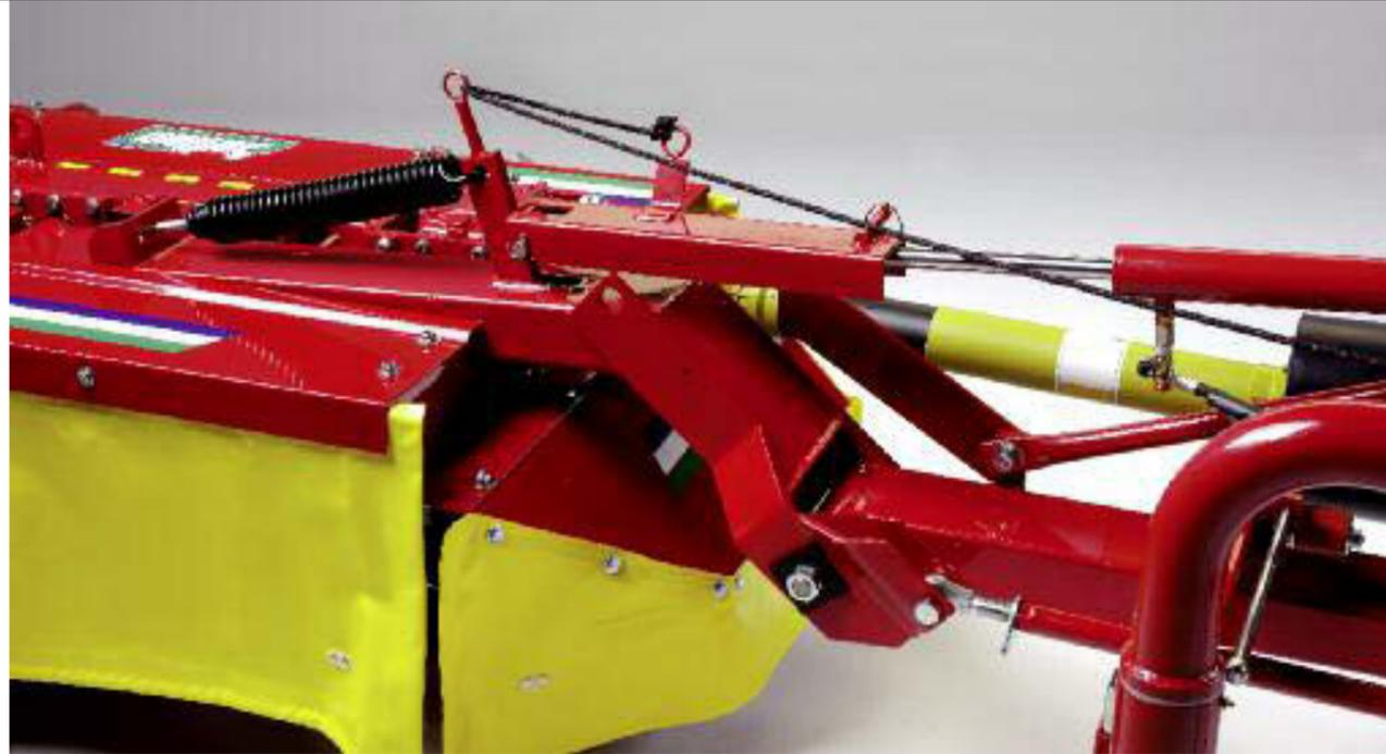
L'attacco a tre punti con barra oscillante, permette di operare nelle migliori condizioni: durante il lavoro il doppio movimento oscillante consente alla falciatrice di adattarsi al terreno e una molla di compensazione alleggerisce il peso della falciatrice caricandolo sul trattore.
